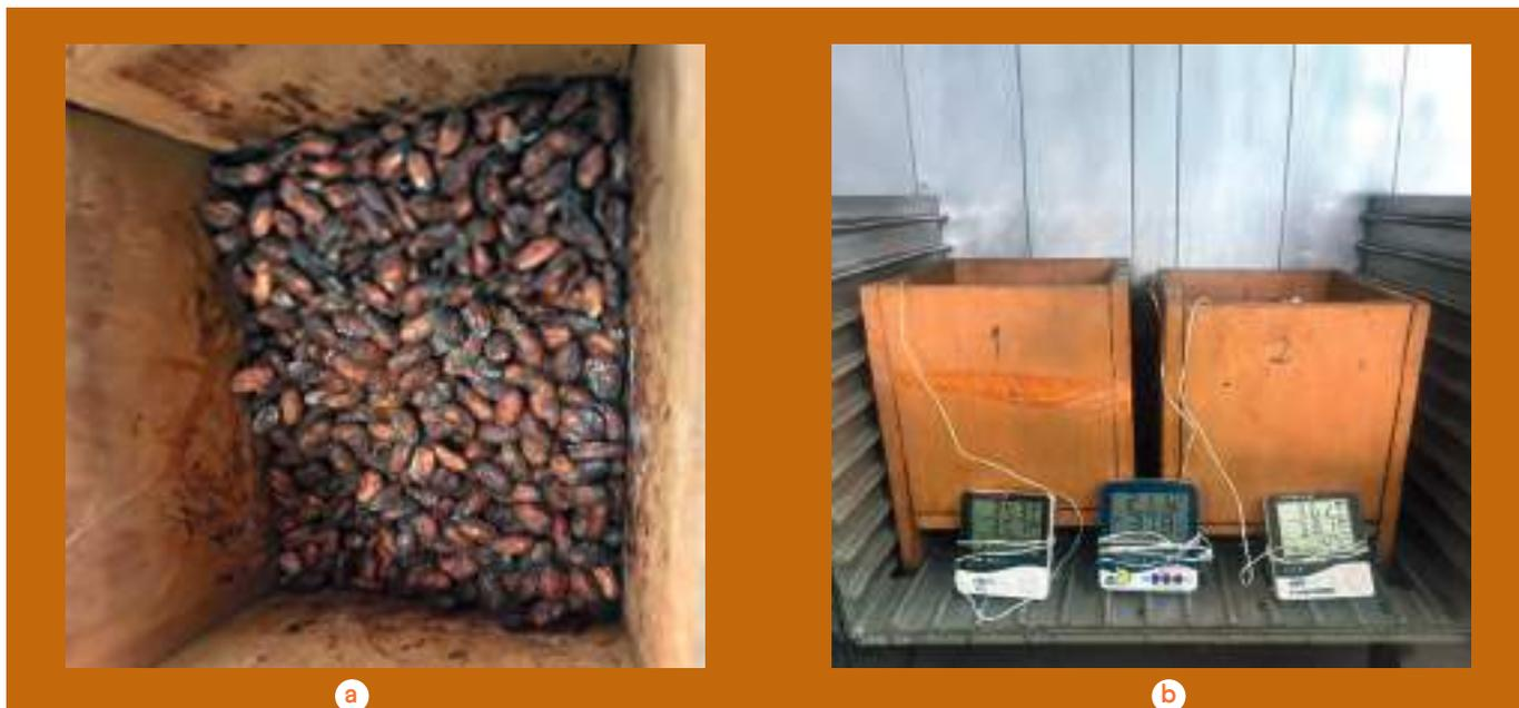
**Figura 3.** Proceso de fermentación del cacao CCN 51: a) Vista interior de la caja de fermentación y b) Vista exterior con medición de temperatura
