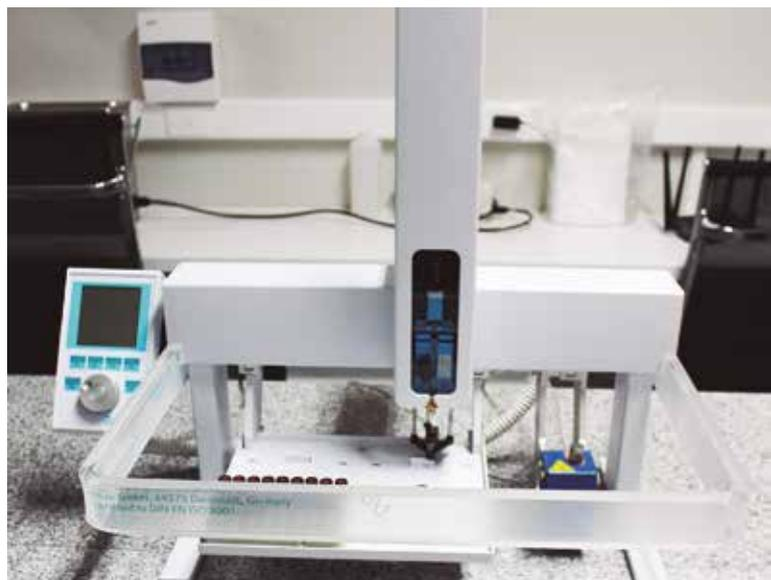
Figura 3. Analizador isotópico de agua líquida para determinar Oxígeno 18 y Deuterio.
