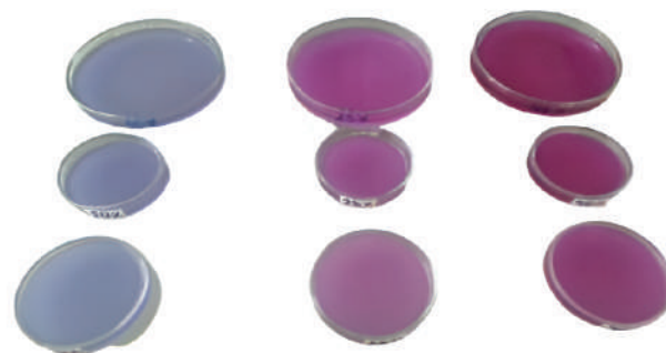
Figura 3. Películas colorimétricas inteligentes elaboradas a base de almidón, CMC y antocianinas
